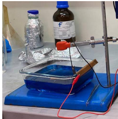
Установка для электролитического осаждения меди на контактном слое мембраны
